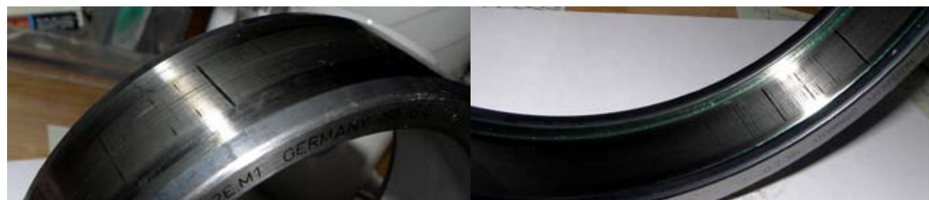
Rys. 13. Ślady uszkodzeń bieżni wewnętrznej
