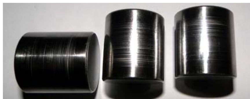
Rys. 12. Ślady uszkodzeń elementów tocznych
