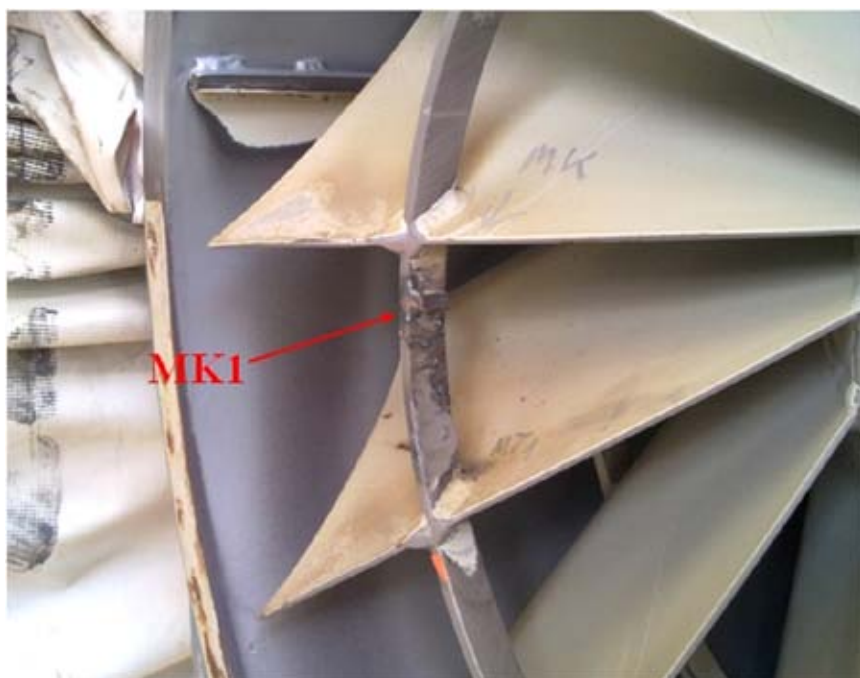
Rys. 1. Wirnik wentylatora z masą korygującą niewyważenie
