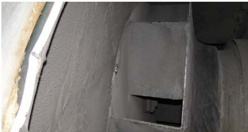
Rys. 7. Wirnik wentylatora z masą korygującą niewyważenie
